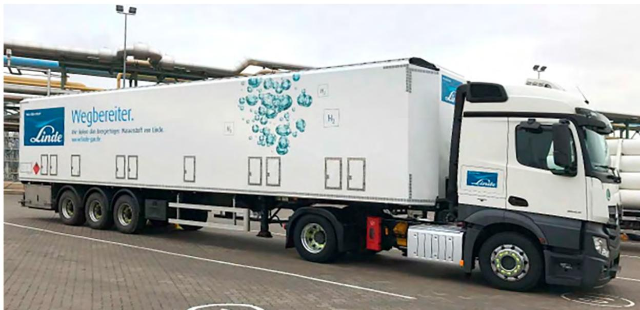
Abbildung 4-4 Wasserstofftrailer von Linde (Quelle: Linde)
